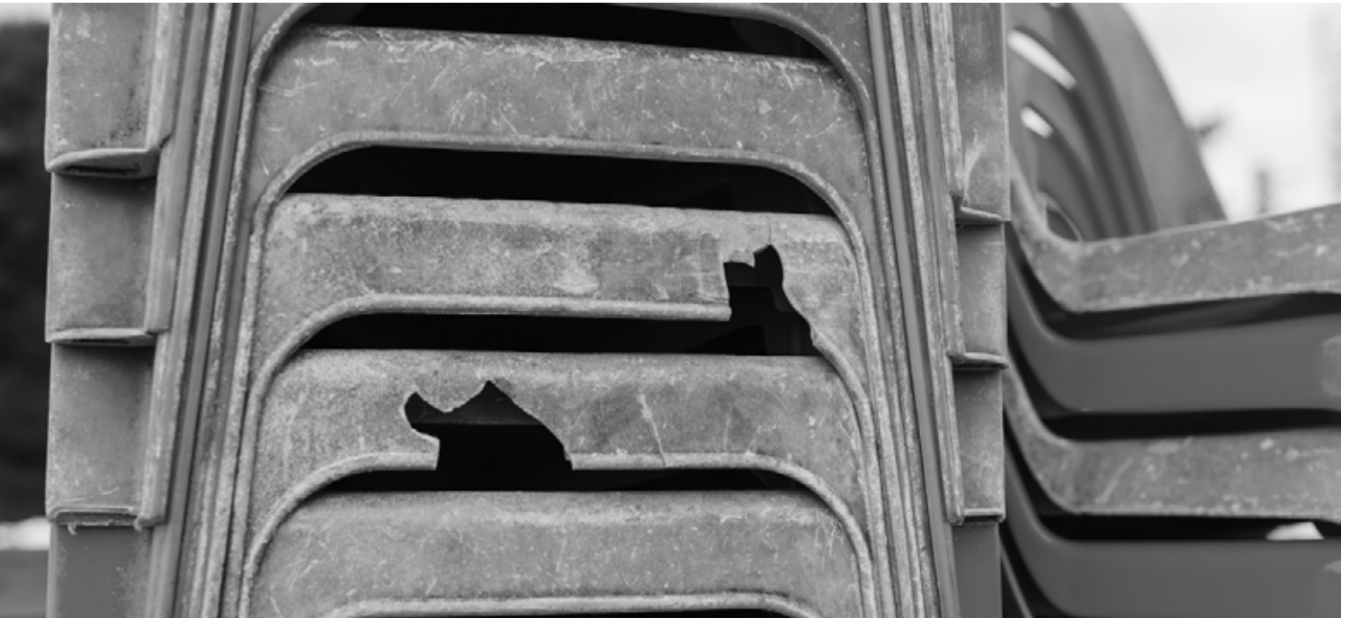
Durch Sonnenstrahlung stark angegriffene Gartenstühle aus Polypropylen
